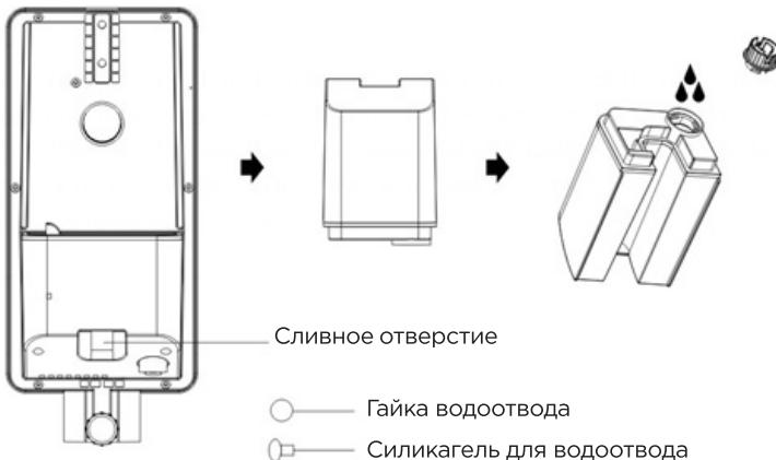
Шаг 1: снимите резервуар, потянув его вверх, старайтесь не разлить при этом воду
